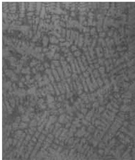
Fig. 4. Schliffbild einer Legierung mit 59,1 Gew.-Proz. Ag + 20,4 Gew.-Proz. Au + 20,5 Gew.-Proz. Cu. Legierung aus dem Konzentrationsgebiet des heterogenen Gefüges innerhalb A B C der Fig. 1. Kokillenguß. Vergrößerung und Ätzung wie Fig. 2.
